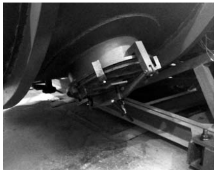
图11 试验设备稳压段人孔盖
